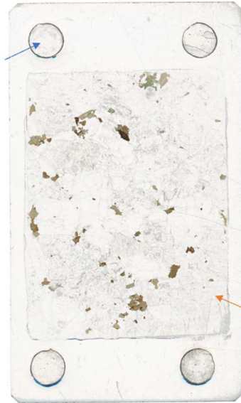
図1：白雲母マーカーを設置した岩石薄片サンプルの開発
