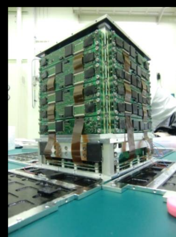
組み立て後のChubuSat-2衛星と中性子検出用放射線センサ
